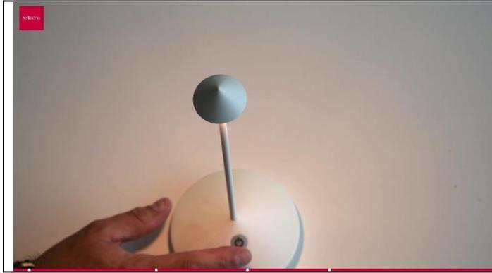
Durch Betätigen des Schalters am Lampenfuss die Funktionstüchtigkeit testen. Es kann nötig sein, die Akkus vorgängig zu laden.
