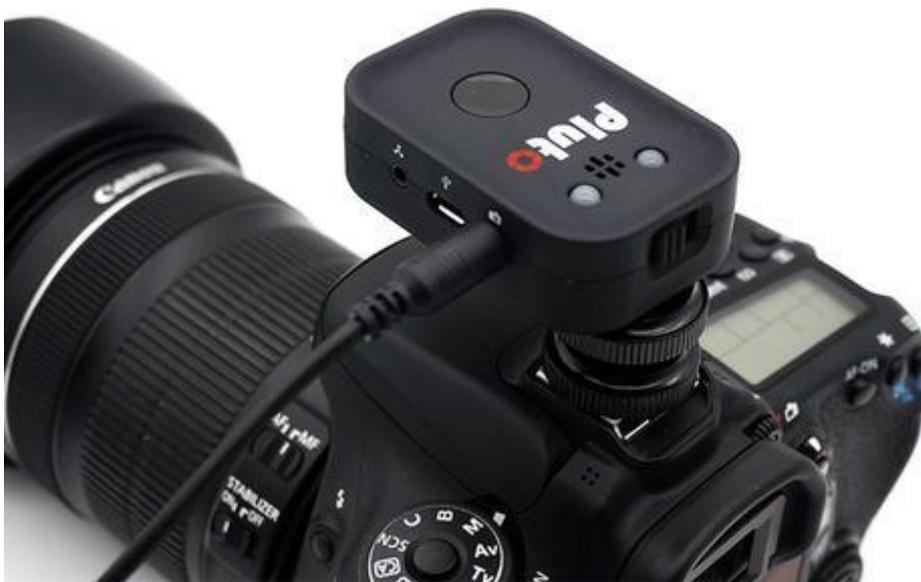
Verbinden Sie mit dem Verbindungskabel den Pluto Trigger.
