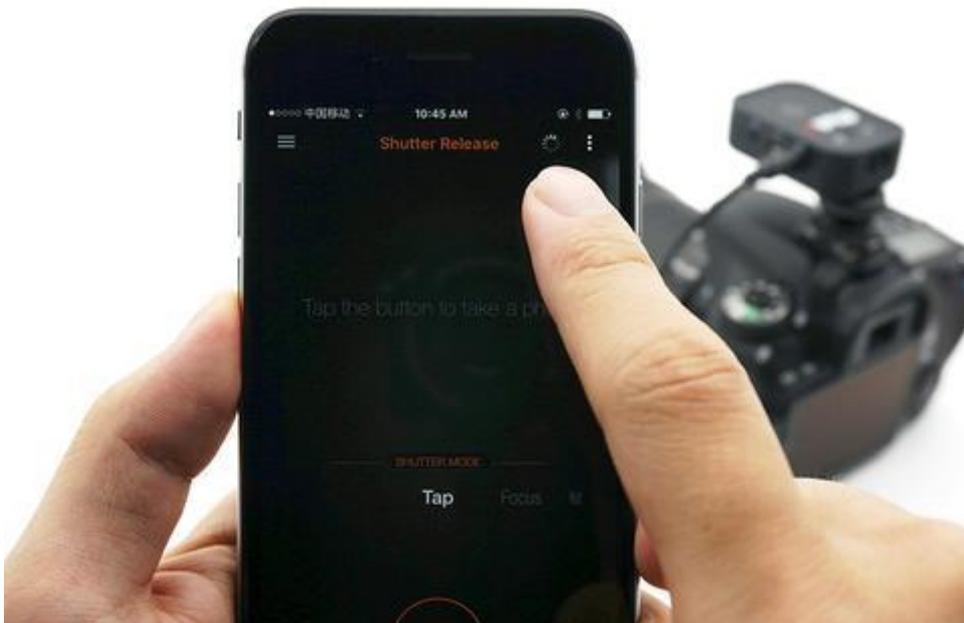
Für die Erstbenutzung, müssen Sie die App mit dem Pluto Trigger verbinden. Später wird die App das Telefon mit dem Pluto Trigger verbinden. **Koppeln Sie nicht mit den Bluetooth-Einstellungen von iOS oder Android, dies wird abgelehnt.**
