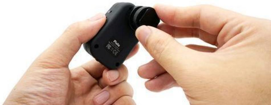
Schrauben Sie den Blitzschuh-Adapter unter den Pluto Trigger.
