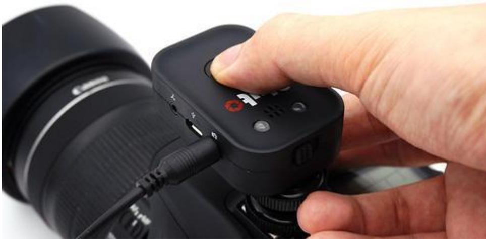
Wenn die App den Pluto Trigger im letzten Schritt erkennt, gehen Sie zum nächsten Schritt, oder versuchen den Pluto Trigger zu starten und drücken Sie den Knopf für 5 Sekunden bis die LED 3 Mal blinkt. Dann ist das Bluetooth aktiviert. Wenn die LED einmal blinkt ist das Bluetooth deaktiviert.
